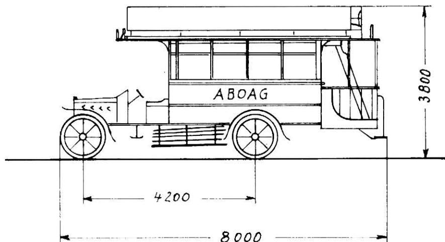
Fußboden über Fahrbahn 820 mm
