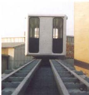
Die Verwendung motor- und tragradloser Fahrzeuge, die einfache Konstruktion des Fahrweges sowie die ortsfeste Installation der Antriebseinrichtung und Steuerung senken den Wartungsaufwand etwa entsprechend dem geminderten Investitionsaufwand. Dazu kommt der Wartungsvorteil der ortsfesten statt im Fahrzeug angeordneten Technik.
