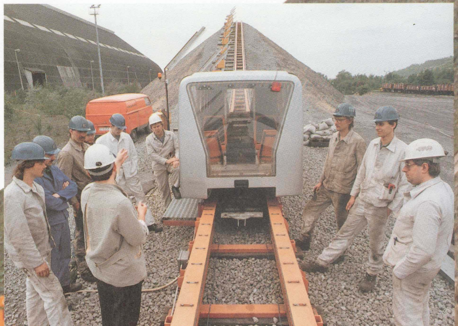
3 Entladespirale auf dem Zechengelände General Blumenthal, drei Phasen beim Entladen einer Wanne in Fahrt
