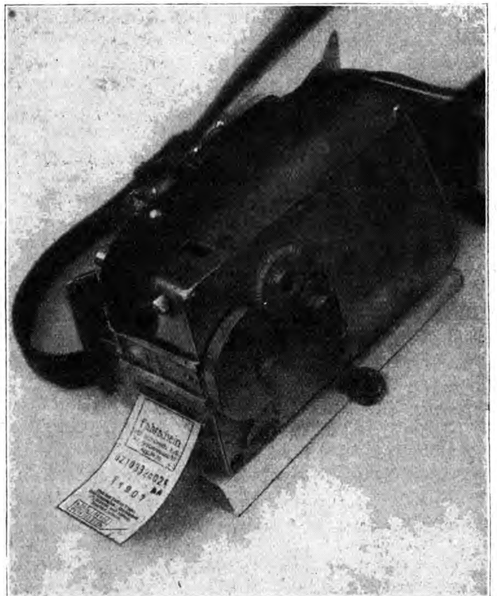
Abb. 2. Hänel & Schwarzscher Hüftapparat, Aufblick von rechts; man erblickt die Kurbel und die scheibenförmige Einstellvorrichtung für Fahrscheine für Erwachsene oder Schüler auf der Aussenseite des Apparates.
